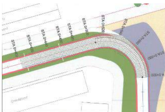
Gbr. 9. Area Pemasangan CMC pada Zone 1 yaitu STA 0+400 sampai STA 0+600.
