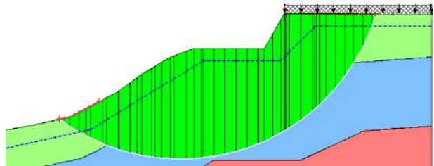
Gbr. 4. Bidang Longsor Lereng (SF = 0,856).
